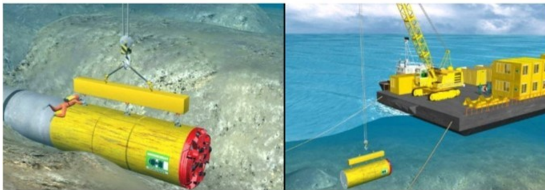
Figura 3.5: Schema indicativo di recupero della fresa di scavo nel punto di uscita a mare del microtunnel
