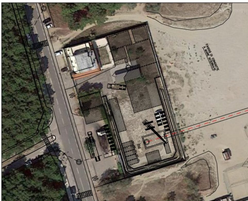
Figura 11.1: Ubicazione del pozzo di spinta e area di lavoro del microtunnel (stralcio DIS-AT-D-31503_r2)
